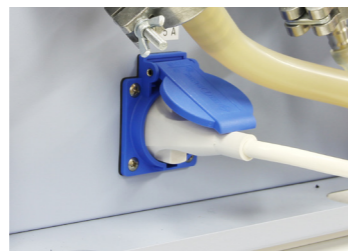
Gniazdko do podłączenia i sterowania pompą próżniową
