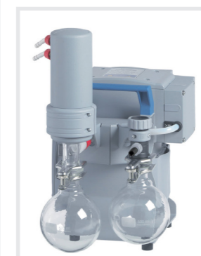
Vacuubrand MZ 2C NT AK+EK (2,0m³/h, erreichbares Vakuum 7 mbar)
