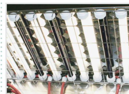
Cámara con la VIS-UV fuente de luz combinada o separada con el mando propio y evaluación automática de test de fotoestabilidad.
